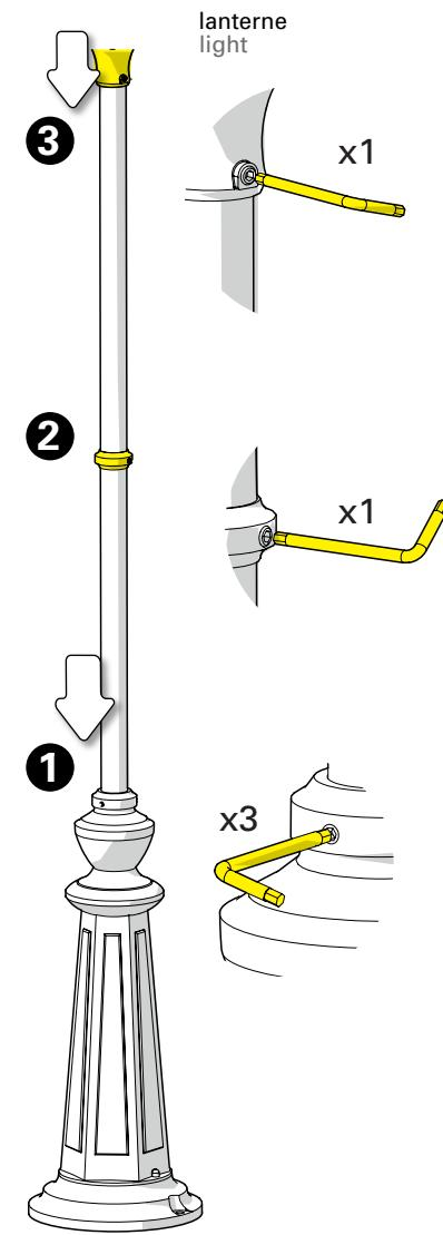
**3** Raccordement électrique & fixation du luminaire
